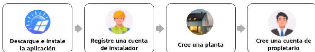
Figura 7-6 Despliegue de una planta nueva
