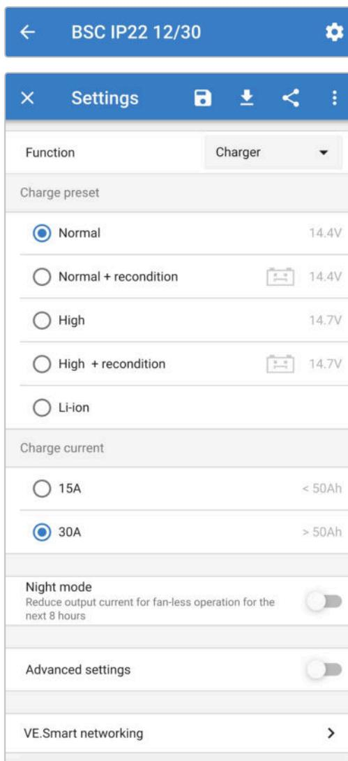
8. Seleccione el modo más apropiado de las preconfiguraciones de carga integradas (normal, normal + reacondicionamiento, alto, alto + reacondicionamiento o iones de litio) en el menú "Charge preset" (preconfiguraciones de carga). Se iluminará el LED situado al lado del modo de carga seleccionado en ese momento (NORMAL / HIGH / LI-ION (normal/alto/iones de litio)), además del LED RECONDITION (reacondicionamiento) si está habilitada.
