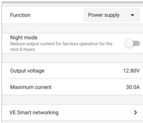
Para devolver la función del cargador a su uso como cargador de baterías normal, siga los pasos 1 a 3 anteriores y seleccione el modo "Cargador" (cargador) en el menú desplegable "Function" (función).
