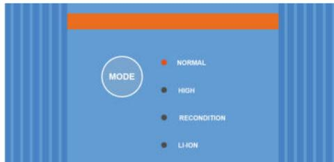
3. Si es necesario, habilite el modo corriente baja (corriente de carga limitada al 50 % de la máxima corriente de carga nominal y ventilador desactivado). Para habilitar (o deshabilitar) el modo de corriente baja mantenga pulsado el botón MODE durante 6 segundos. Cuando esté habilitado, parpadeará el LED NIGHT (noche).
