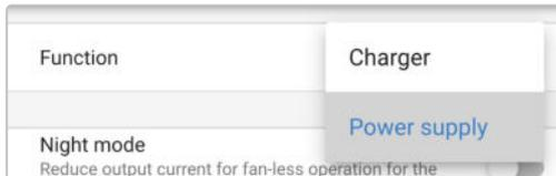
6. Ahora estará habilitado el modo "Power supply" (fuente de alimentación). Cuando esté habilitado se encenderán los LED de BULK (carga inicial), ABS (absorción), FLOAT (flotación) y STORAGE (almacenamiento).
