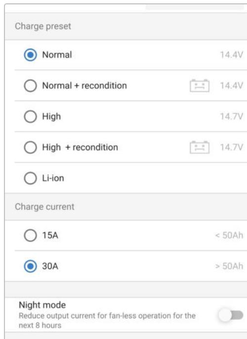
El cargador almacenará automáticamente el modo de carga seleccionado y lo recordará para futuros ciclos de carga (incluso después de desconectarlo de la alimentación).
