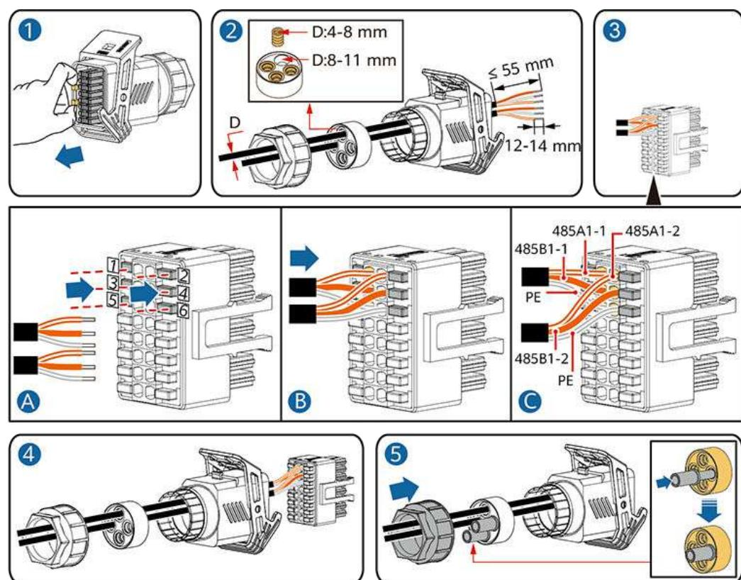
**Paso 2** Conecte el conector del cable de señal al puerto de comunicaciones.
