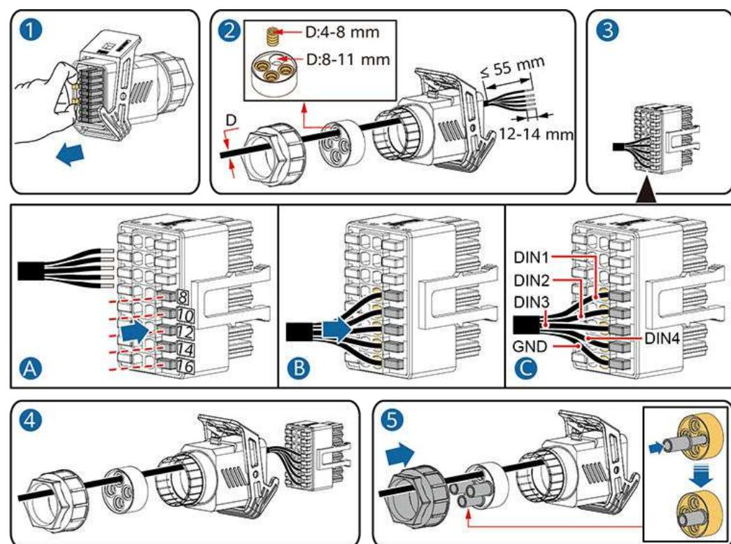
**Paso 2** Conecte el conector del cable de señal al puerto de comunicaciones.
