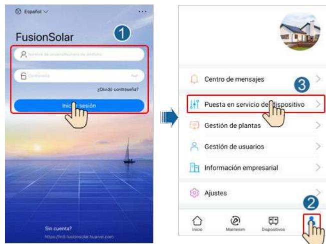
**Paso 2** Conéctese a la red WLAN del inversor solar e inicie sesión en la pantalla de puesta en servicio del dispositivo utilizando el usuario **installer**.
