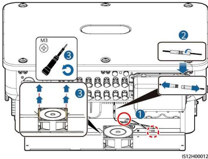
**Paso 3** Instale el ventilador nuevo siguiendo los pasos anteriores en el orden inverso, amarre el cable del ventilador y vuelva a conectarlo.
