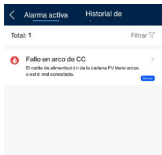
Figura 7-3 Eliminación de la alarma
