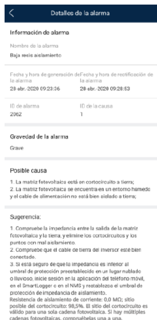
Figura E-1 Detalles de alarma
