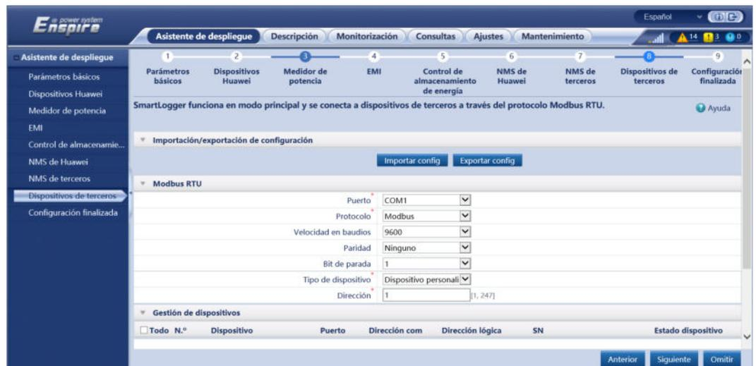
9. Configure el parámetro **Encendido/apagado de la matriz** según los requisitos del sitio. La configuración ha finalizado.
