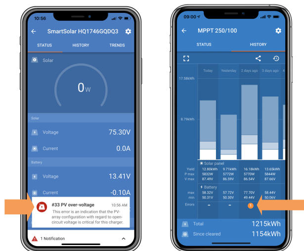
Aplicación VictronConnect: captura de pantalla de un error n.º 33 y del historial indicando un error
