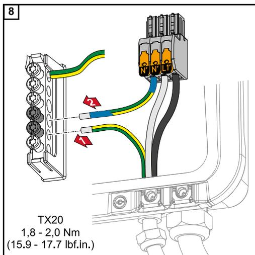
Fijar el conductor protector (PE) y el conductor PEN al borne de electrodo de tierra con un destornillador (TX20) y un par de apriete de 1,8 - 2 Nm.
