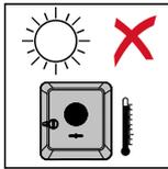
Para que el inversor se caliente lo menos posible, no debe exponerse a la radiación solar directa. Montar el inversor en una posición protegida, por ejemplo, debajo de los módulos solares o debajo de un saliente de tejado.
