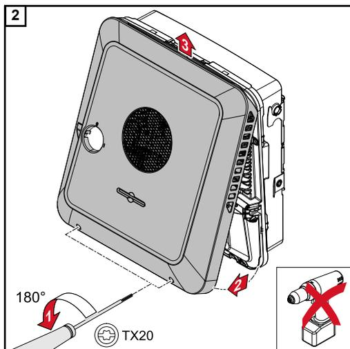
Alojar los tornillos de la parte inferior de la cubierta de la carcasa con un destornillador (TX20) y girándolos 180° a la izquierda. Luego, levantar la tapa de la carcasa en la parte inferior del inversor y desengancharla hacia arriba.
