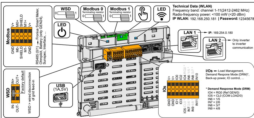
Borne Push-in para la instalación de Modbus 0, Modbus 1, 12 V y GND (Ground)
