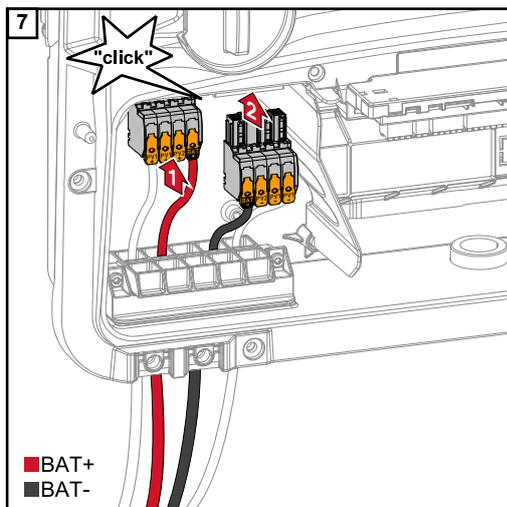
Encajar y enclavar los bornes de conexión CC en el puesto correspondiente.
