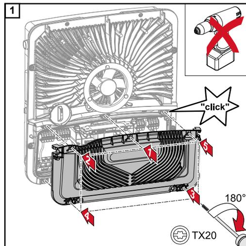
Colocar la cubierta en la zona de conexión. Apretar los cinco tornillos en el orden especificado con un destornillador (TX20) y un giro de 180° a la derecha.
