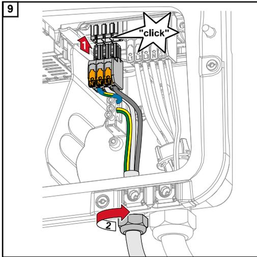
Encajar y enclavar el borne de conexión OP en el puesto OP. Apretar la tuerca de sombrerete de la descarga de tracción con el par de torsión especificado por el fabricante.
