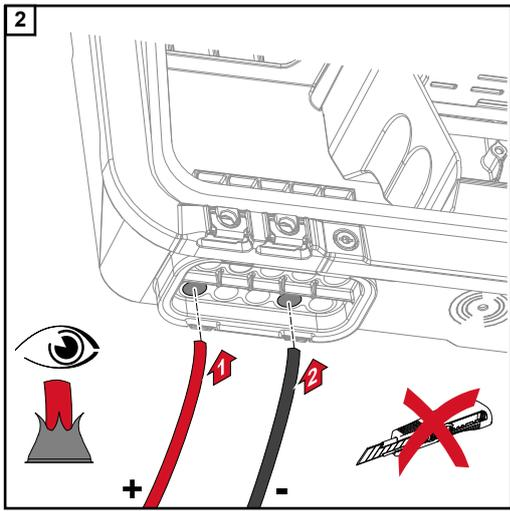
Empujar los cables de CC a través de los pasos de cable de CC con la mano.
