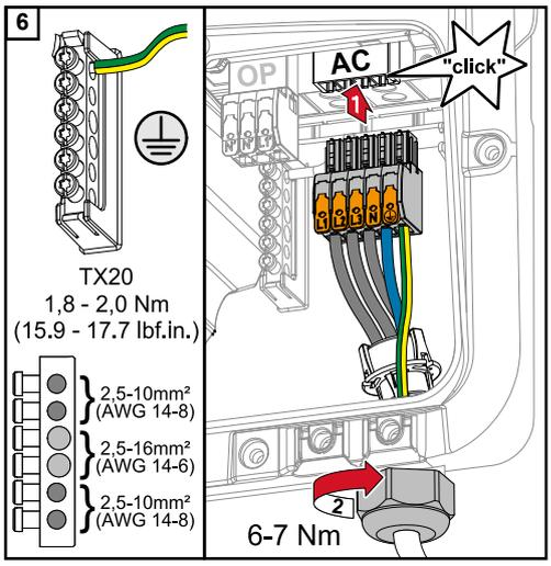
Encajar y enclavar el borne de conexión CA en el puesto de CA. Fijar la tuerca de sombrerete de la descarga de tracción con un par de 6-7 Nm.
