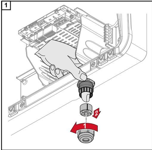
Alojar la tuerca de sombrerete de la descarga de tracción y presionar el anillo de junta con los tapones ciegos desde el interior del dispositivo.
