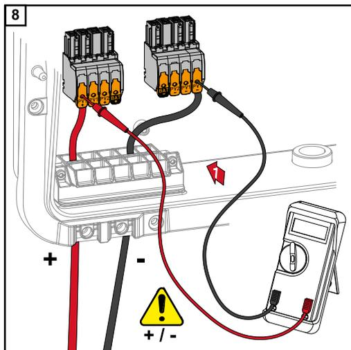
Comprobar la tensión y la polaridad del cableado CC utilizando un aparato de medición adecuado. Retirar los dos bornes CC de los puestos.
