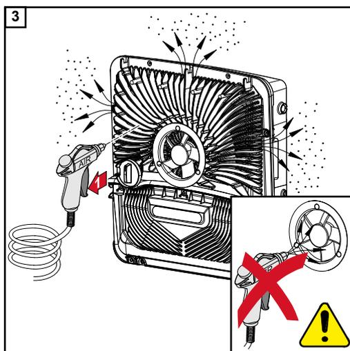
Limpiar los depósitos de suciedad del disipador de calor y del ventilador con aire comprimido, un paño o un cepillo.
