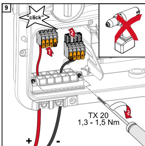
Encajar y enclavar los bornes de conexión CC en el puesto correspondiente. Fijar los tornillos del portacables con un destornillador (TX20) y un par de 1,3 - 1,5 Nm en el chasis.
