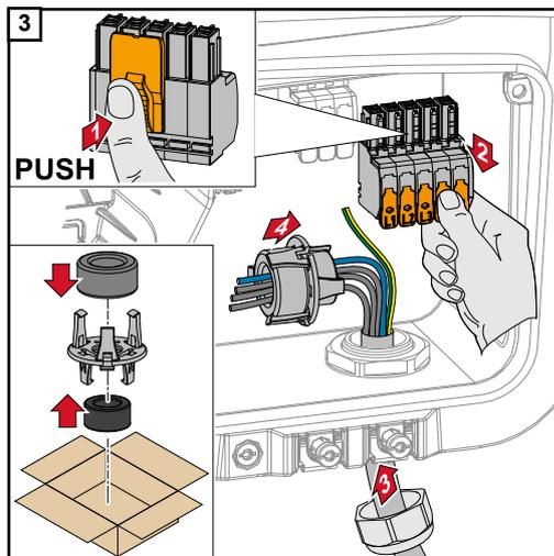
Presionar el bloqueo en la parte posterior del borne de conexión y retirar el borne de conexión CA.
