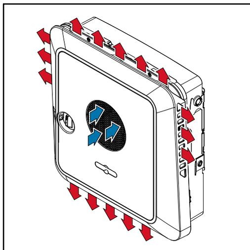
El ventilador aspira el aire ambiente en el frontal y lo expulsa por los laterales del equipo. La evacuación uniforme del calor permite la instalación de varios inversores unos al lado de otros.
