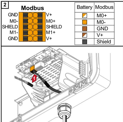
Insertar los cables en el puesto correspondiente y comprobar que se mantienen en su lugar.
