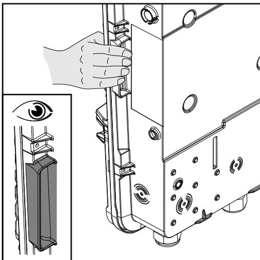
El inversor incluye asas en los laterales para facilitar la elevación y que pueda engancharse.
