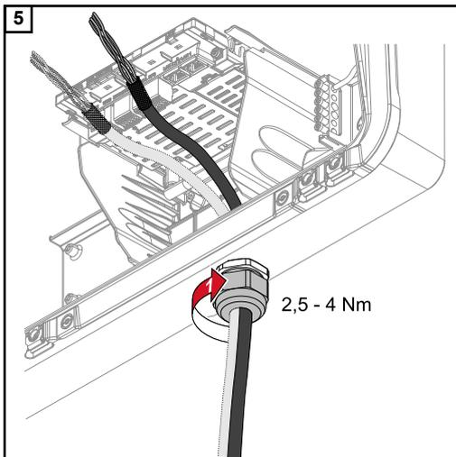
Fijar la tuerca de sombrerete de la descarga de tracción con un par de 2,5 - 4 Nm como máximo.
