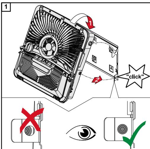
Colgar el inversor desde arriba en el soporte de fijación. Las conexiones deben estar orientadas hacia abajo.
