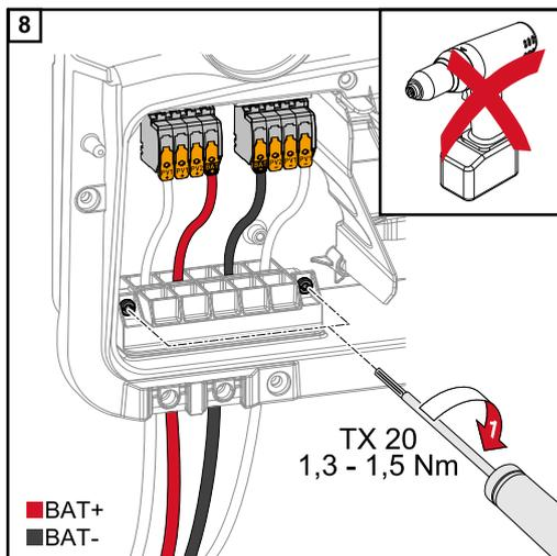
Fijar los tornillos del portacables con un destornillador (TX20) y un par de 1,3 - 1,5 Nm en el chasis.
