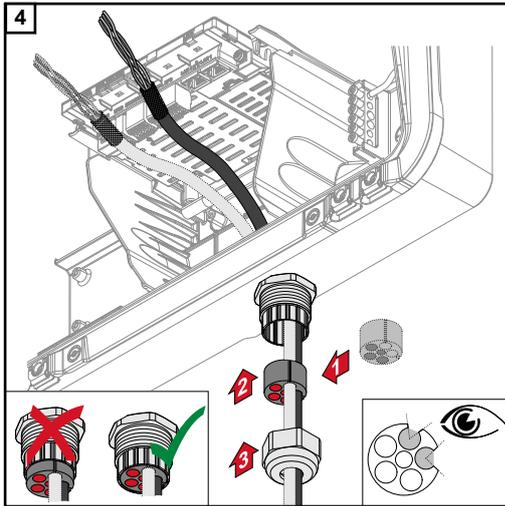
Introducir el anillo de junta entre la tuerca de sombrerete y la abertura del chasis. Introducir a presión los cables de datos en el portacables de la junta. Luego, presionar la junta hasta el borde inferior de la descarga de tracción.
